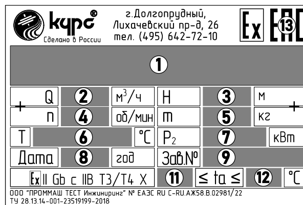
Рис. 2 Табличка электронасоса КММ-ЕЛ
